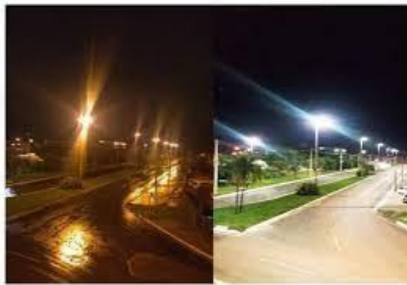
Figura 4 - Diferença entre Fontes de Sódio x LED
